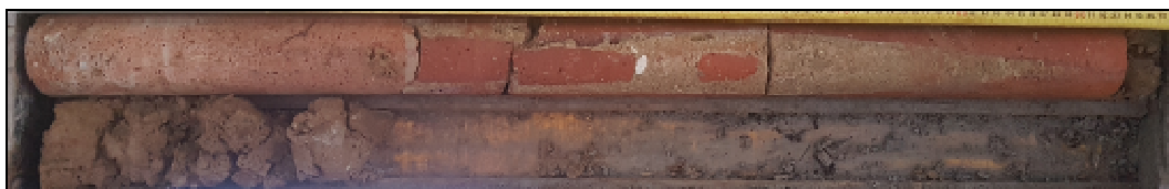
Obr. č. 1 - diagnostický vrt V2
